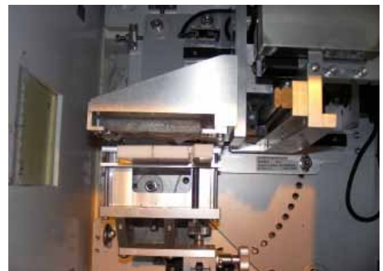
写真3 二次元元素分布測定装置。スライスしたコンクリート試料が固定されている。
