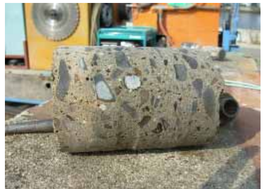
写真1 コア抜きしたコンクリート体。
