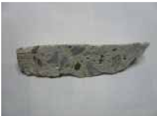
写真2 スライスしたコンクリート試料。左側がコンクリート体の表面。
