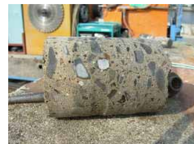
写真2 コア抜きしたコンクリート試料
