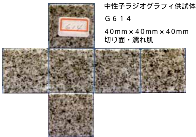
G614 (左) と稲田石 (右) の中性子ラジオグラフィ像 2007年トライアルユース 1回目
