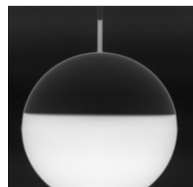
図4 推進薬チタンタンクの中性子ラジオグラフィー画像
