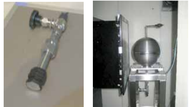
図1 1/2inチタン配管（左）および推進薬タンク（右） 配管内径は 10.7mm,管厚1mm. タンク外径 160mm, 壁厚1mm. 材料はいずれもチタン合金（Ti-6Al-4V）. 無水ヒドラジン充填のため、入口にバルブがそれぞれ装着されている。
