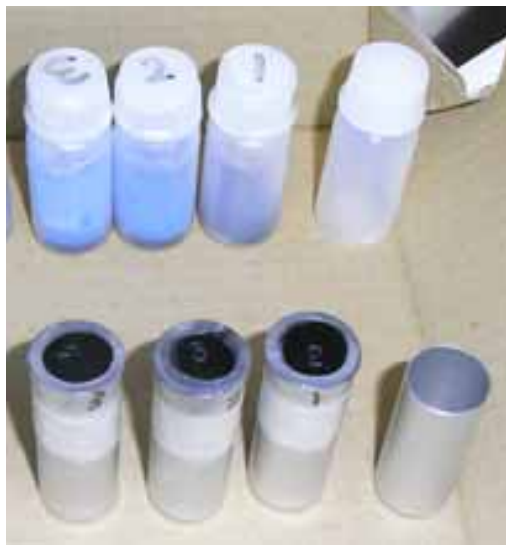
図1 現像剤を封入したサンプル(手前; アルミニウム素材、奥; テフロン素材)
