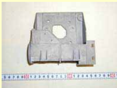
図1 実験対象例(ダイキャスト品)
