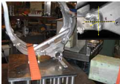
図1 フレーム残留応力測定状況
