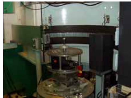
図1 HRPD 測定の外観（左：中性子入射、中央：回転試料台、奥：検出器群、右：ビームストッパ（B4C））
