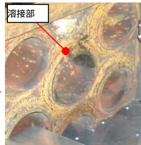
図1 試験体外観形状及び計測状況（写真は周方向応力計測時）
